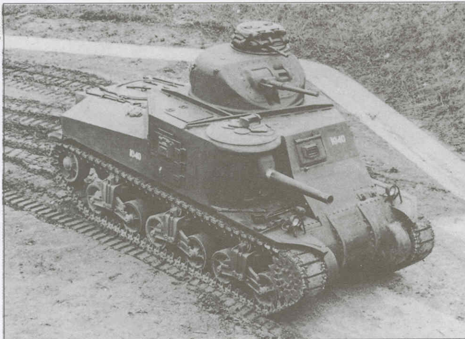
Средний танк М3А2, изготовленный фирмой Baldwin Locomotive Works. Абердинский полигон, 1 января 1942 года
